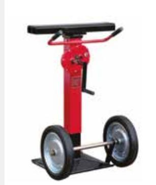
Sistema de seguridad para cargar o descargar el semirremolque sin cabeza tractora evitando la rotura de los pies de apoyo o que el semirremolque pueda volcar durante el proceso. Elevación del semirremolque en carga. Soporte basculante con protector de goma.
